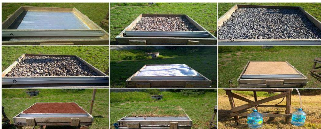
**Figura 1:** A) impermeabilização, B,D) Brita grossa, C) Brita miúda, E) Manta acrílica, F) Areia, G)Terra, H)FORAGEIRA, I)VEDAÇÃO, fonte: Autor
