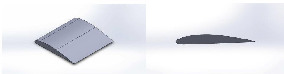
**Figura 3** – Desenho realizado do perfil NACA 4412.
