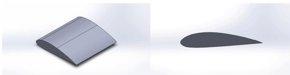
**Figura 4** – Desenho realizado do perfil NACA 4418.
