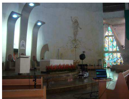
Figura 1 – Equipamentos distribuídos para realização da medição acústica na Catedral: Fonte dodecaédrica, software Dirac e Microfone.
