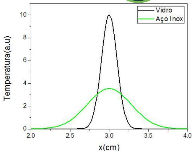
**Figura 2** – Comparação o perfil da temperatura para materiais com diferentes difusividade térmica: vidro ( $D=5 \times 10^{-3} \text{ cm}^2/\text{s}$ ) e ferro ( $D= 4 \times 10^{-2} \text{ cm}^2/\text{s}$ ).
