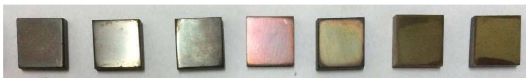
Figura 1 – Amostras tratadas termicamente, classificadas por temperatura e tempo de tratamento: 500°C/6h, 500°C/12h, 450°C/1h, 450°C/6h, 450°C/12h, 400°C/6h e 400°C/12h (da esquerda para a direita).
