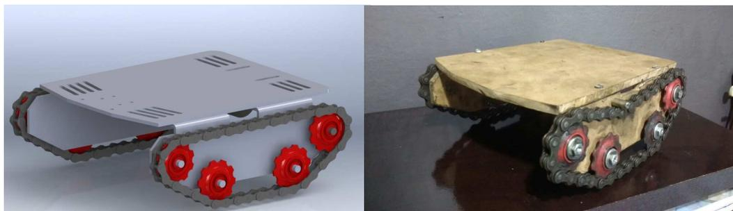
**Figura 2** – Modelo CAD e estrutura real da base do robô.
