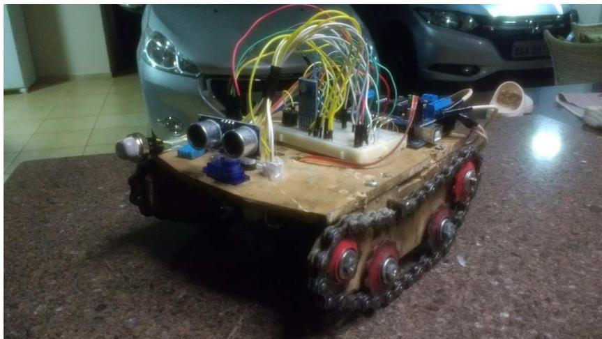
**Figura 3** – Robô com o circuito e sensores acoplados.
