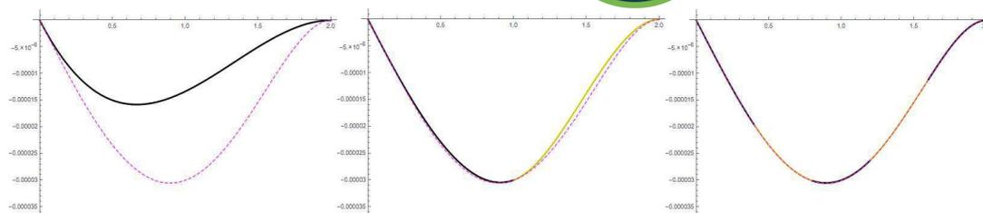
**Figura 2** – gráficos comparativos de 1, 2 e 5 elementos finitos, respectivamente.
