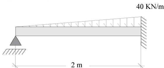
**Figura 1:** ilustração do carregamento e vinculações do exemplo.
