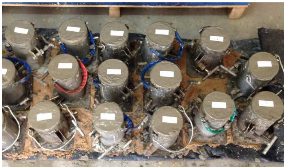
Figura 1: Corpos de prova, moldados e identificados.
