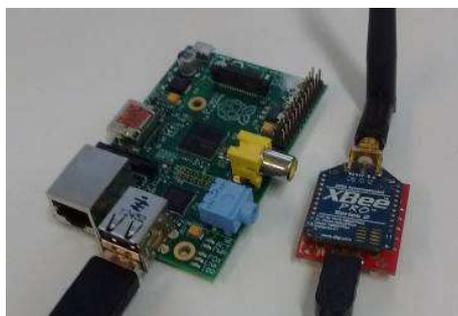
Figura 1 - Protótipo receptor dos dados
