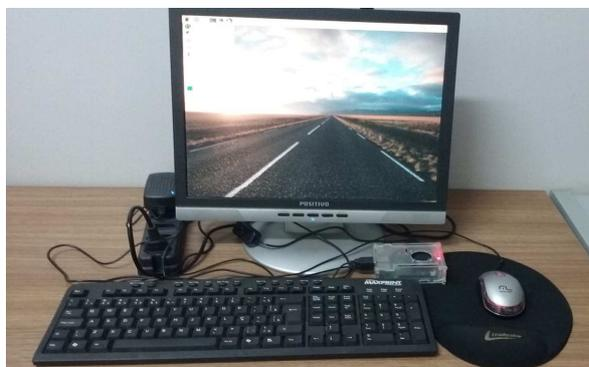
**Figura 1** – Raspberry Pi 3 com teclado, mouse e monitor de vídeo.
