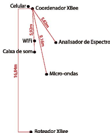
Figura 1 – Posicionamento de cada dispositivo na residência
