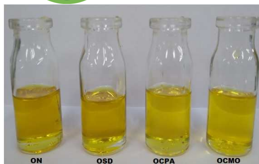
Figura 1 – Espectro de varredura (a) e imagem digital (b) do óleo de soja antes e após os diferentes tratamentos de limpeza. ON: óleo neutralizado; OSD: óleo tratado com semente desengordurada; OCPA: óleo tratado com carvão comercial PA; OCMO: óleo tratado com carvão produzido com a semente da Moringa oleífera .
