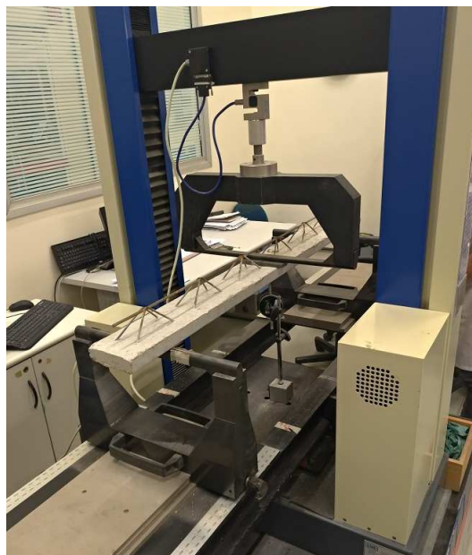
Figura 2 – Vigota biapoiada na prensa
