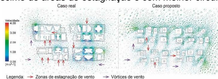
**Figura 1** – Corte horizontal a 16m mostrando o efeito barreira.
