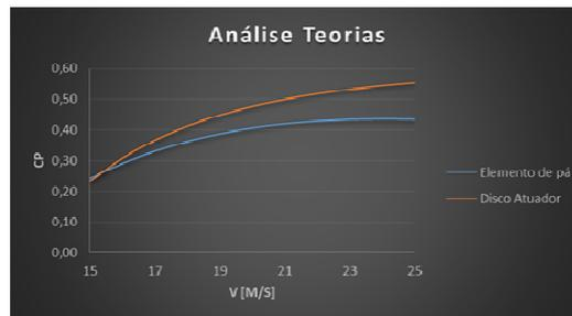
Figura 1 - Gráfico  $C_p$  para as teorias BEM e disco atuador.
