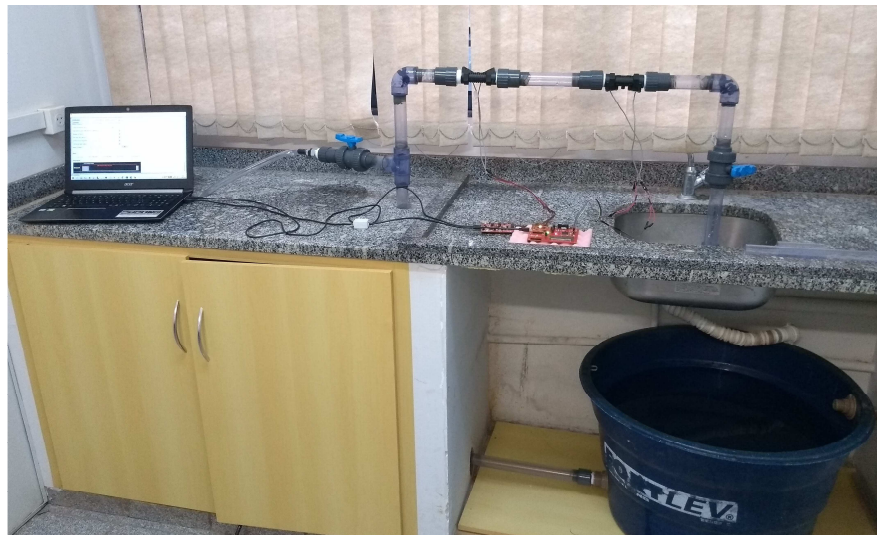
Figura 1 – Sistema hidráulico utilizado para realização dos ensaios.
