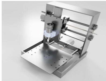
Figura 2.a - microfresadora projetada
