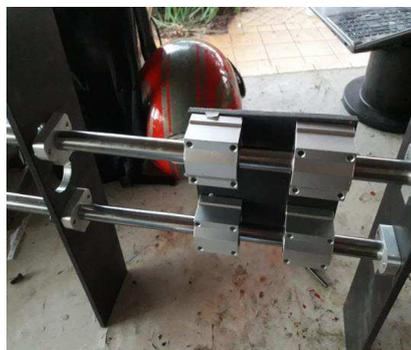
Figura 2.b - microfresadora em construção
