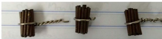
Figura 1 – Feixe de capilares aço inox 304 e 316
