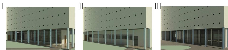
Figura 4 – I) Esquadrias moduladas e varanda com espelho d'água, as-designed , II) Alteração com o avanço de paredes, demolição do espelho d'água e esquadrias e III) intervenção do Fábrica Arquitetura, com um pano de vidro deslocado dos pilares.
