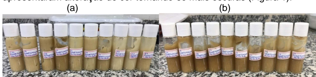
Figura 1 - Características macroscópicas dos emulgéis, demonstrando a mudança de coloração após estudo de estabilidade preliminar de 12 dias após o ciclo de congelamento e descongelamento: (a) tempo 0; (b) tempo 12, após 12 dias.
