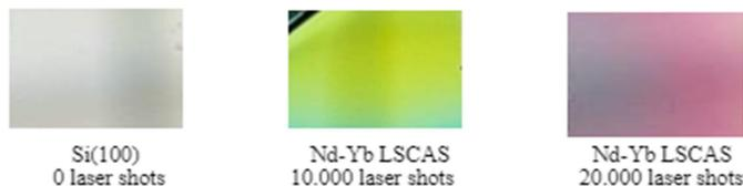
Figura 1 – Três filmes de vidro sobre o silício cristalino.
