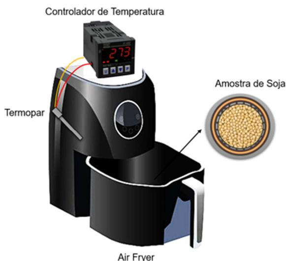
Figura 1 – Secador construído
