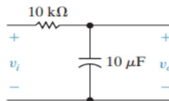
**Figura 2** – Filtro RC passa-baixas para o exemplo da Transformada de Fourier.
