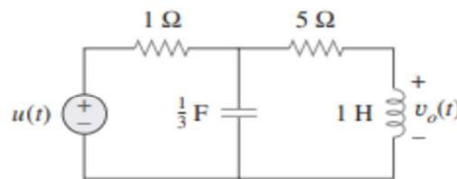
**Figura 1** – Esquema do circuito para o exemplo da Transformada de Laplace.
