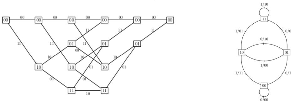
**Figura 2 - (a):** Diagrama de treliça para o codificador da Figura (1). **(b):** Diagrama de transição de estados para o codificador da Figura (1).
