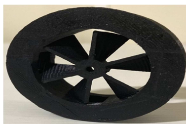
Figura 3 – Impelidor da turbina produzido com FFF
