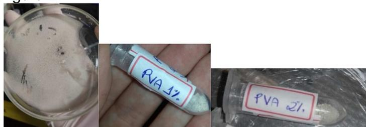
Figura 2. Imagens das amostras preparadas com: 0%, 1% e 2% PVA e carregamento *in situ* de NpSe 10% (m/v).
