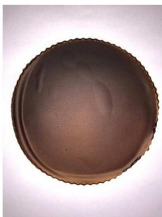
Figura 1 – Filme SPI+CMC com extrato 14% de aroeira-vermelha.
