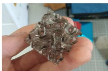
**Figura 3:** Fotografia do giroide impresso na resina aditivada com GO.
