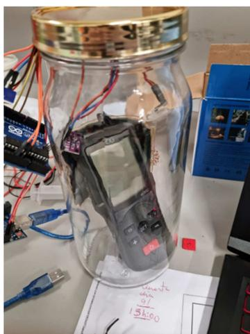
Figura 1 – Sistema de calibração do sensor SGP30.
