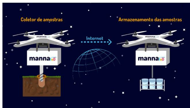
**Figura 2** – Ilustração do protótipo para coleta de amostras do solo acoplável à *drones*.
