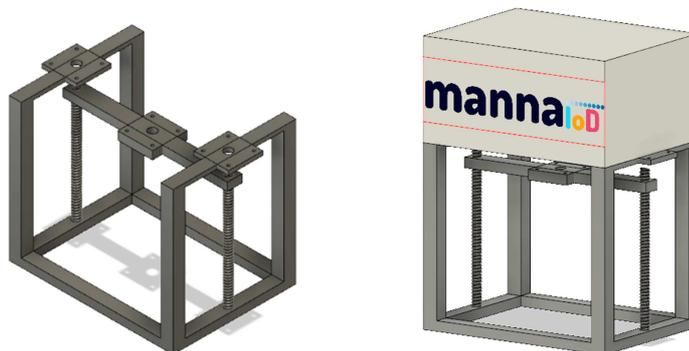
Figura 4 – Estrutura de sustentação do sistema de coletor de amostras.
