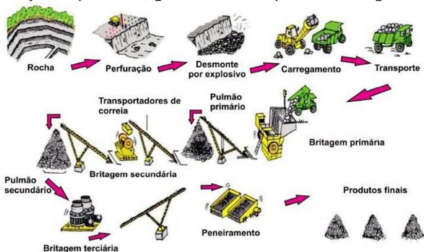
FIGURA 1 – Situação esquemática de uma planta de britagem de rocha
