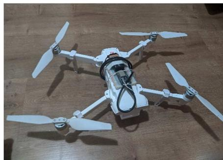
Figura 1.b – ESP8266 conectado ao drone.
