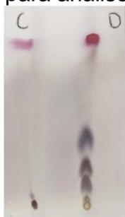
**Figura 3:** Cromatografia em camada delgada do extrato bruto (C) e dos produtos da reação (D).
