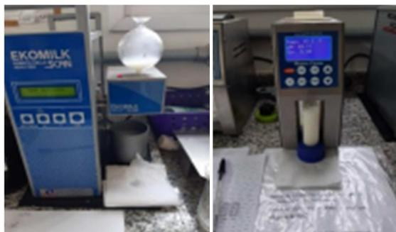
**Figura 1** – Análise de CCS no equipamento EkomilkScan e composição no equipamento Master Classic
