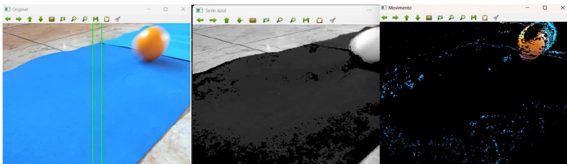
**Figura 1** – Fruta em movimento sob vista lateral em imagem original, remoção de fundo azul e detecção de movimento respectivamente.
