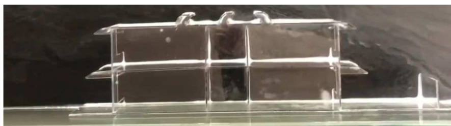
Figura 2 – Ensaio da maquete a partir de um corte de um dos blocos do CAP/UEM realizado em mesa d'água (acervo do autor, 2023)
