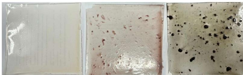
**Figura 1** – Filmes obtidos pelo método de *casting*. Da esquerda para a direita: filme controle, filme com de microcápsulas do extrato e filme com microcápsulas da polpa, respectivamente.
