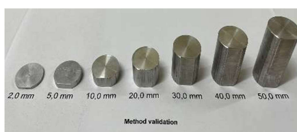
Figura 1 - Peças de Alumínio (puro) produzidas como padrão para validação metodológica.
