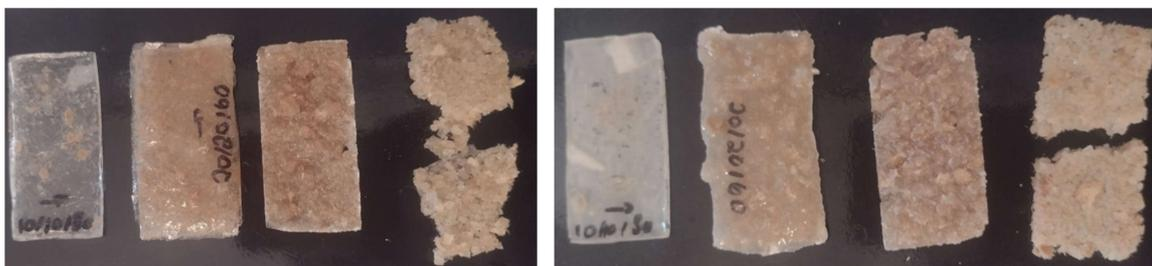
**Figura 3** – Corpos de teste organizados na sequência (A, B, C e D). À esquerda, após o teste de resistência estrutural a baixas temperaturas. À direita, após o teste de absorção de água.
