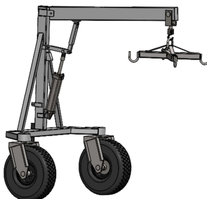
Figura 2: Equipamento de içamento de big bags.
