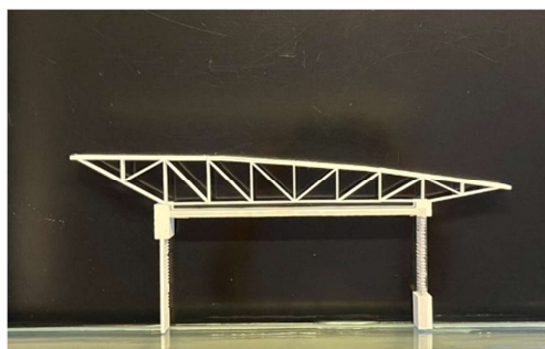
Figura 01 – Maquete do corte da escola primária em Gando impressa em PLA na cor branco fosco (acervo do autor, 2025)
